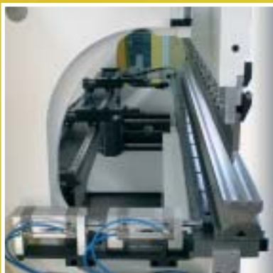
Sistema pneumatico di cambio cava controllato dal CNC Pneumatic system for die changing controlled by the CNC
