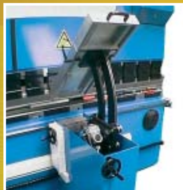
Accompagnatori lamiera automatici controllati dal CNC Automatic sheet support controlled by the CNC
