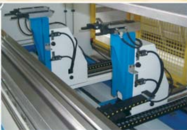
Registro posteriore a 6 assi con riferimenti pneumatici Six axes backgauge with pneumatic fingers X 1 -X 2 -R 1 -R 2 -Z 1 -Z 2
