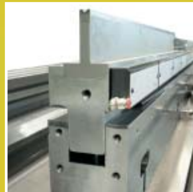
Utensile inferiore speciale pneumatico Special pneumatic lower tool
