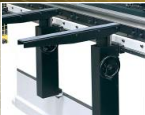
Squadre anteriori traslabili e regolabili in altezza Sliding and adjustable support arm
